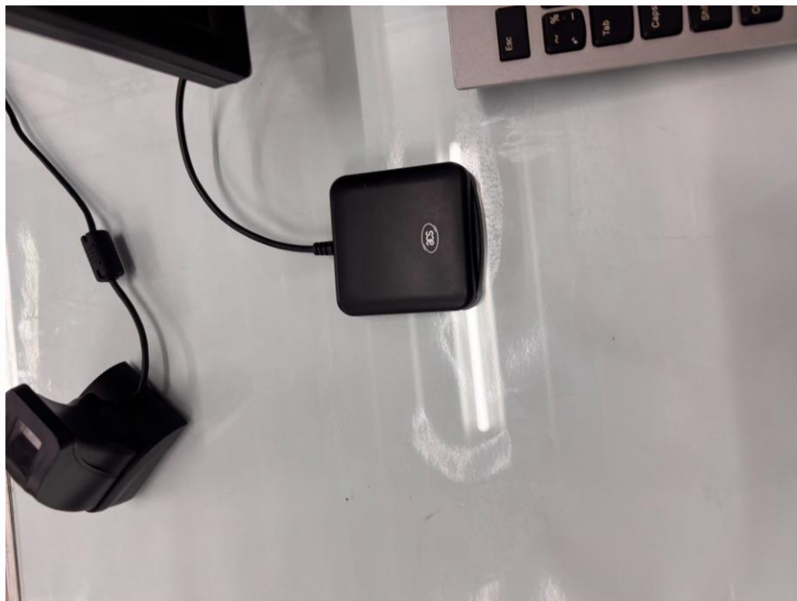
ภาพที่ 9.4: ภาพขยายอุปกรณ์ Smart Card Reader (ACS) และ Fingerprint Scanner ที่ใช้ในกระบวนการยืนยันตัวตนผู้เรียน (ตัวอย่างสถานที่: บริษัท แอดวานซ์ จันทน์ (2017) จำกัด)
