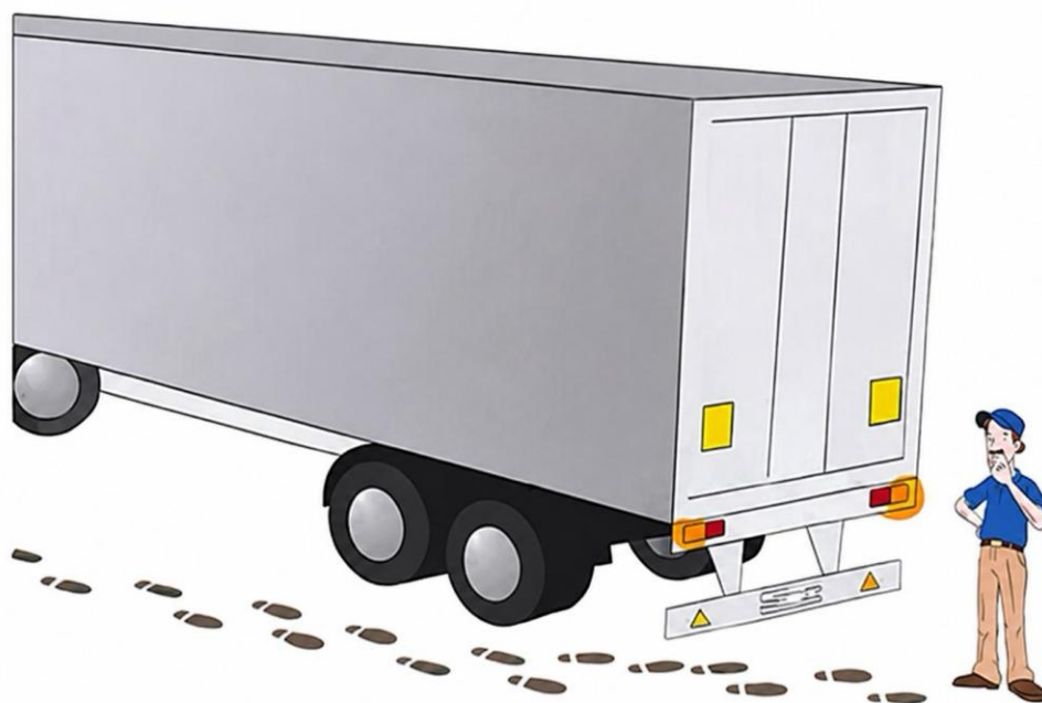
ภาพที่ 3.24 ตัวอย่างการตรวจสอบความพร้อมบริเวณด้านหลังของหางลาก (Trailer)
