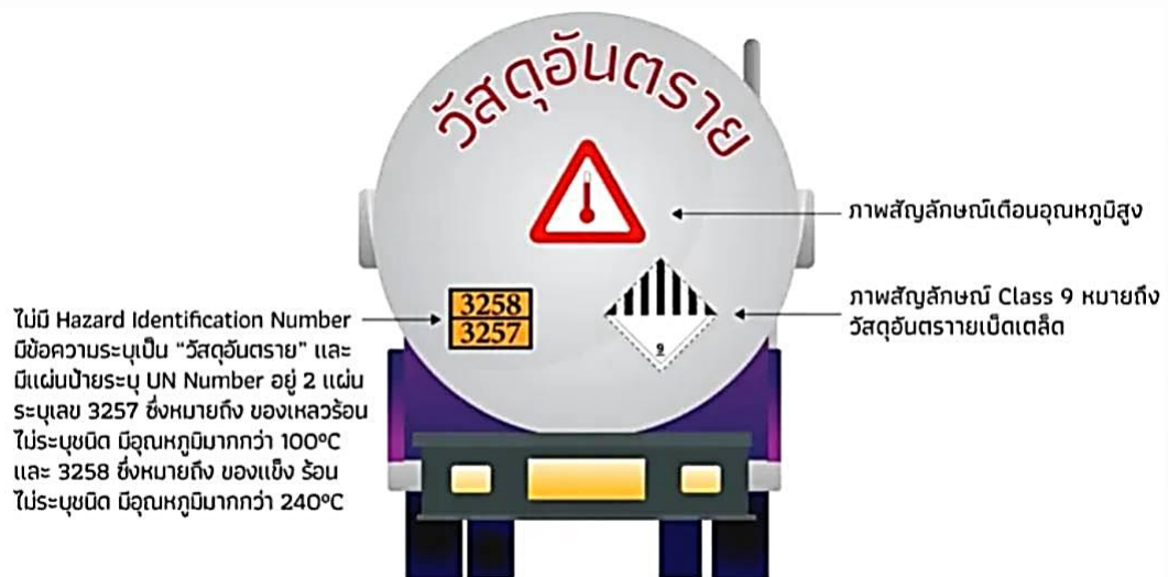
ภาพที่ 6.36 ความหมายรูปสัญลักษณ์การขนส่ง (Transport Pictograms) บนหน่วยขนส่งวัตถุอันตราย ที่บ่งชี้ว่าเป็นรถขนของเหลวผสมของแข็งชนิดหนึ่งที่มีอุณหภูมิสูงมาก (รถขนยางมะตอย)
