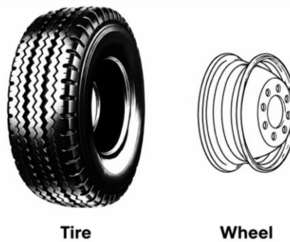
ภาพที่ 3.9 ตัวอย่างยางชนิดไม่ใชยางในประกอบใส่ยาง 2 ชิ้นส่วน
