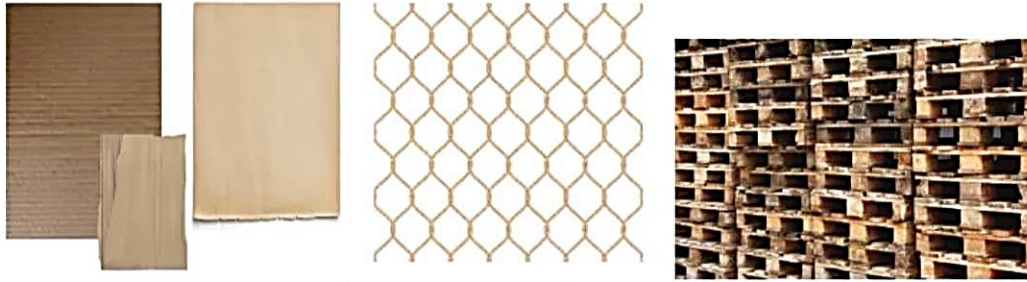
ภาพที่ 6.15 วัสดุเติมช่วยเพิ่มแรงเสียดทาน
