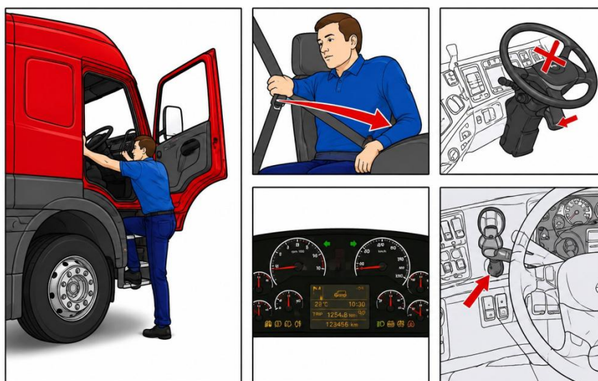
ภาพที่ 3.40 ตัวอย่างการตรวจสอบความพร้อมบริเวณภายในห้องโดยสาร
